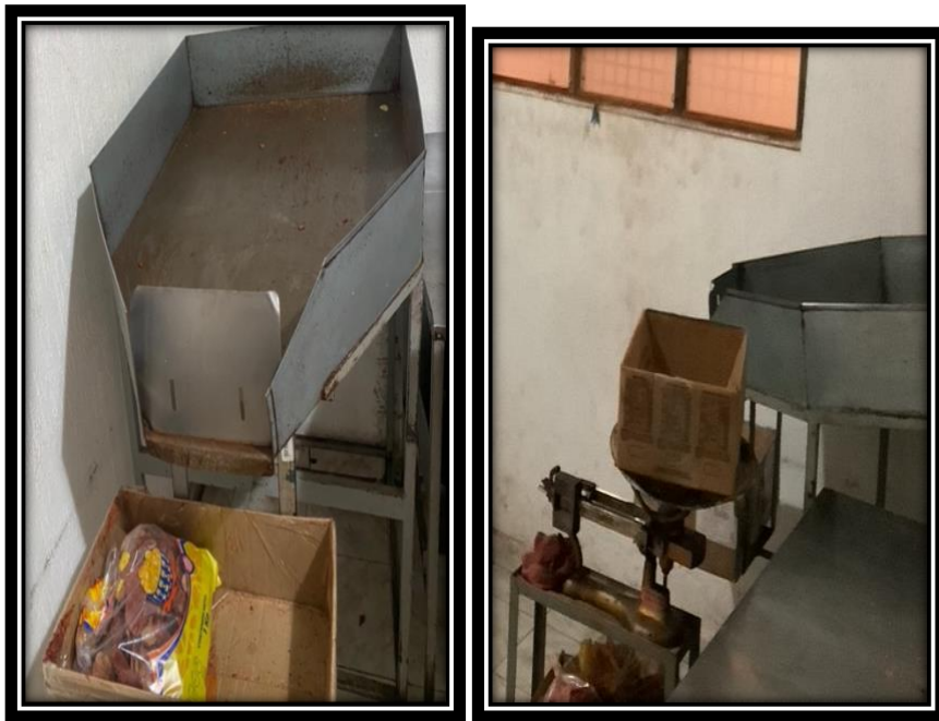
Figura n. ° 49 Tolva y báscula de envasado en nueva área
