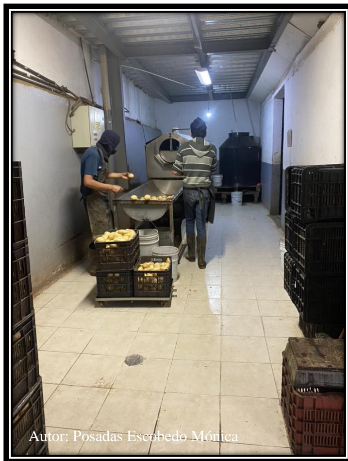
Figura n. ° 51 Área de lavado y pelado con el nuevo equipo
